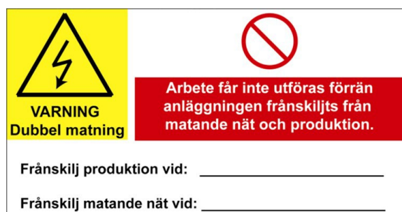
Bild 14. Exempel på skylt som varnar för bakspänning, används när elkopplaren inte sitter i mätarskåpet. Används främst vid strömtrafomätta anläggningar.
